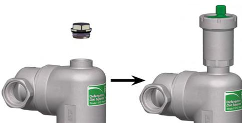
Per l'eventuale installazione della valvola di sfogo aria automatica FAR, rimuovere il tappo superiore e avvitare la valvola. L'attacco superiore è da 1/2" per tutti i modelli di defangatore.
