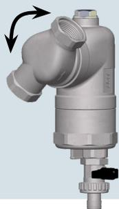
Il defangatore compatto orientabile è adatto all'installazione su tubazioni con disposizione verticale ed orizzontale in quanto la parte con gli attacchi filettati può ruotare di 360° attorno al proprio asse.
