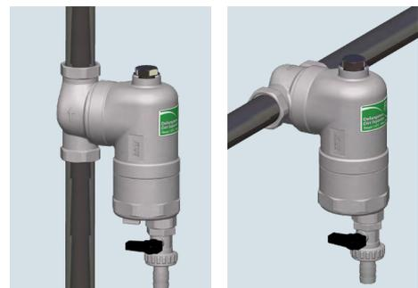
Il defangatore va posizionato sul circuito di ritorno prima dell'ingresso in caldaia, in modo tale da intercettare le impurità che potrebbero danneggiare la caldaia stessa e i circolatori.
